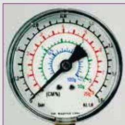
Интерпретация давления. Прямое считывание. Например: если образец весил 50 г, то на зеленой шкале отобразится процент влажности..
