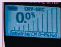
2 - Шкала по безводной стяжке. Звуковой сигнал при достижении значения 0.5%.
