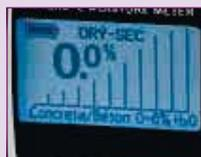
1 - Шкала по бетону. Звуковой сигнал при значении 4.5%.
