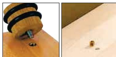
1- Просверлить отверстие Ø 8мм и вставить дюбель
