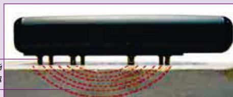
Прибор «VI-D4» определяет значение влажности материала путем измерения его электрического сопротивления. Для этого устройство вырабатывает низкий переменный ток, который измеряется устройством и выдает значение влажности.
