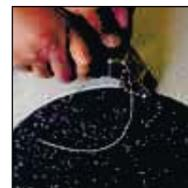
Возможна круговая резка путем снятия заднего лезвия
